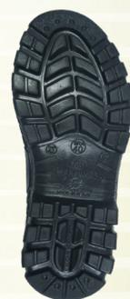
**Solado** Constituído de duas camadas de poliuretano (PU), injetado diretamente no cabedal, sendo a 1ª camada (entressola) mais macia e leve, com densidade de 0,4g/cm<sup>3</sup> proporcionando maior conforto; e 2ª camada (sola) mais compacta com densidade de 1,0 g/cm<sup>3</sup>, resistente a abrasão com sistema antiderrapante constituído de ranhuras especiais de 3mm de altura e 6mm de largura e resistencia ao escorregamento em piso cerâmico e piso de aço (Nível SRC).
