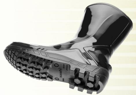
**Solado** Full grip antiderrapante, constituído de uma camada de material polimérico (PVC), com densidade 1,0g/cm<sup>3</sup>, além de ser resistente ao escorregamento em piso cerâmico e piso de aço (Categoria SRC).
